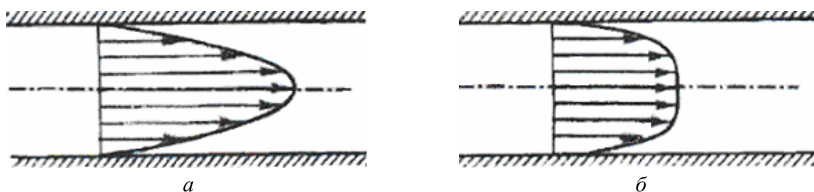
Рис. 3.7. Профиль скорости в трубе: при ламинарном течении жидкости, а ; при турбулентном течении жидкости, б
