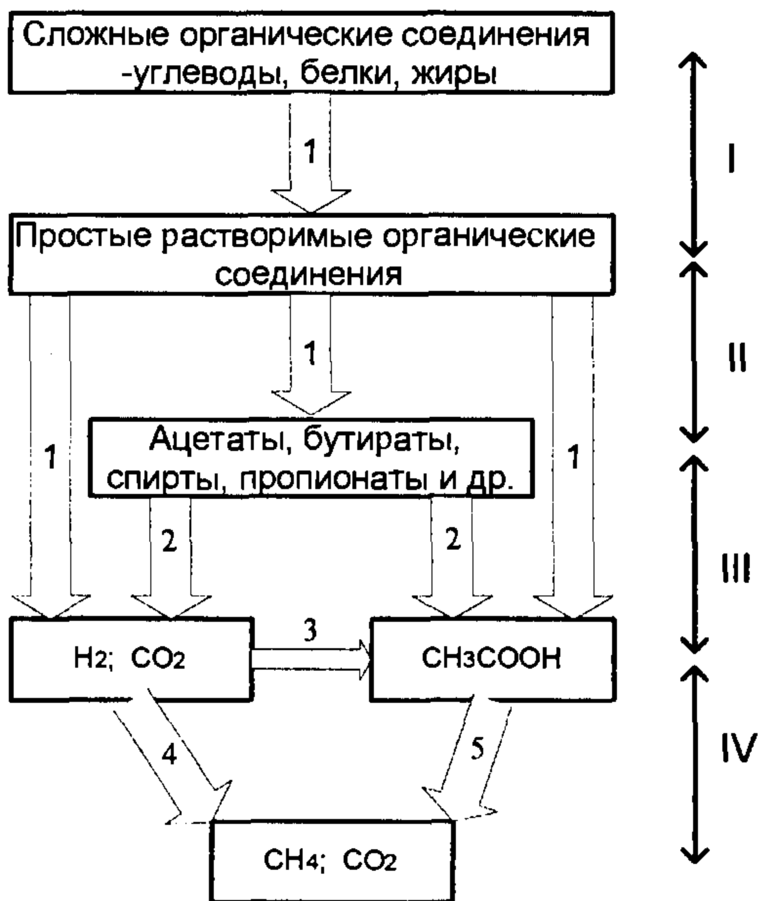
Рис. 15.11. Схема анаэробного метанового сбраживания осадков:
